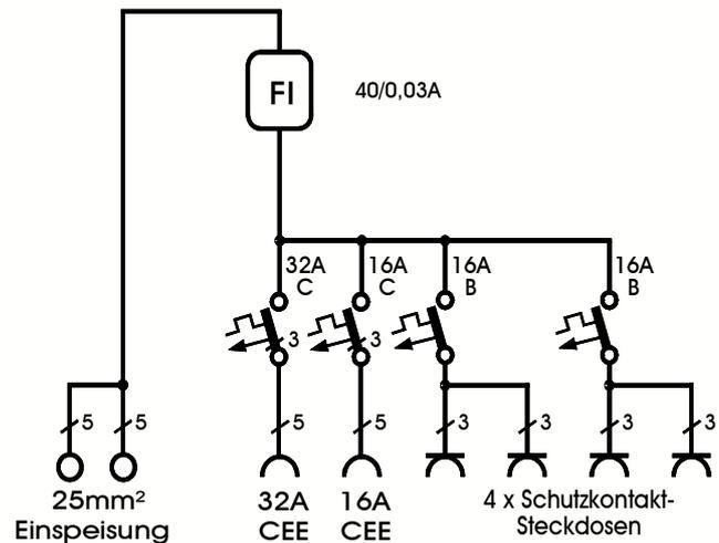
**ELEKTRA** - Steckdosen-Kombination ESTK im Kunststoffgehäuse, spritzwassergeschützt, Schutzeinrichtungen im Deckel montiert, dadurch frei zugängliche Anschlussklemmen, abschließbarer Klarsichtdeckel gegen unbefugtes Betätigen der Schutzeinrichtungen, je 3 vorgeprägte Einführungsöffnungen M32/40 oben und unten für fachgerechten Zuleitungsanschluss, Gehäuse lichtgrau, Maße: BxHxT = 280x325x150mm.
