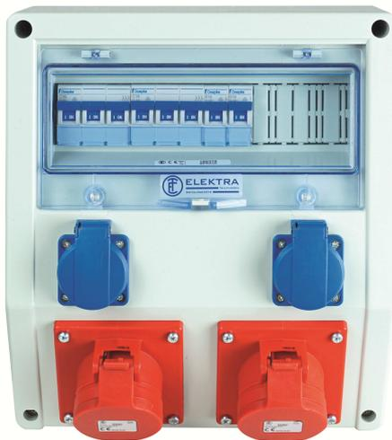
**ELEKTRA** - Steckdosen-Kombination ESTK im Kunststoffgehäuse, spritzwassergeschützt, Schutzeinrichtungen im Deckel montiert, dadurch frei zugängliche Anschlussklemmen, abschließbarer Klarsichtdeckel gegen unbefugtes Betätigen der Schutzeinrichtungen, je 3 vorgeprägte Einführungsöffnungen M32/40 oben und unten für fachgerechten Zuleitungsanschluss, Gehäuse lichtgrau, Maße: BxHxT = 280x325x150mm.
