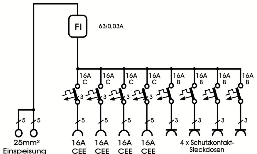
**ELEKTRA** - Steckdosen-Kombination KSTK im Kunststoffgehäuse, spritzwassergeschützt, im Kunststoffgehäuse, Reiheneinbaugeräte unter Klappdeckeln montiert, oben und unten je 1 Bohrung für M40 für fachgerechten Zuleitungsanschluss, Maße: BxHxT = 297x504x190mm.
