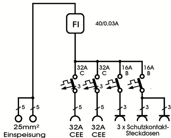
**ELEKTRA** - Steckdosen-Kombination ESTK im Kunststoffgehäuse, spritzwassergeschützt, Schutzeinrichtungen im Deckel montiert, dadurch frei zugängliche Anschlussklemmen, abschließbarer Klarsichtdeckel gegen unbefugtes Betätigen der Schutzeinrichtungen, je 3 vorgeprägte Einführungsöffnungen M32/40 oben und unten für fachgerechten Zuleitungsanschluss, Gehäuse lichtgrau, Maße: BxHxT = 280x325x150mm.
