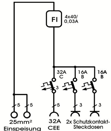
**ELEKTRA** - Steckdosen-Kombination ESTK im Kunststoffgehäuse, spritzwassergeschützt, Schutzeinrichtungen im Deckel montiert, dadurch frei zugängliche Anschlussklemmen, abschließbarer Klarsichtdeckel gegen unbefugtes Betätigen der Schutzeinrichtungen, je 3 vorgeprägte Einführungsöffnungen M32/40 oben und unten für fachgerechten Zuleitungsanschluss, Gehäuse lichtgrau, Maße: BxHxT = 240x251x140mm.
