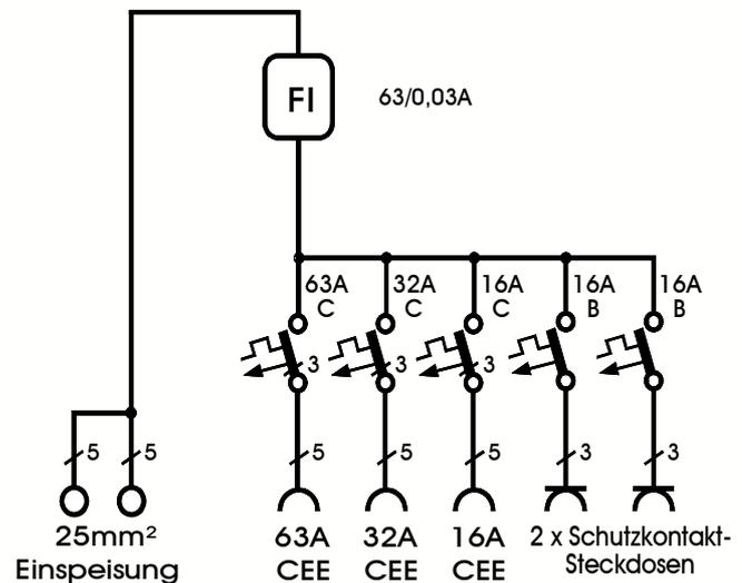
**ELEKTRA** - Steckdosen-Kombination KSTK im Kunststoffgehäuse, spritzwassergeschützt, im Kunststoffgehäuse, Reiheneinbaugeräte unter Klappdeckeln montiert, oben und unten je 1 Bohrung für M40 für fachgerechten Zuleitungsanschluss, Maße: BxHxT = 297x504x190mm.
