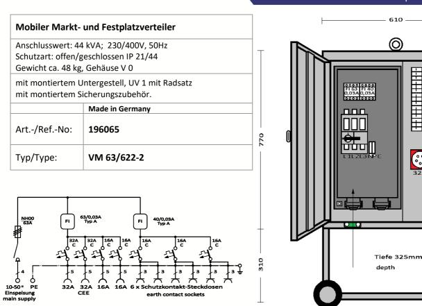
**ELEKTRA** - Stromverteilerschrank im Gehäuse aus verzinktem Stahlblech, pulverbeschichtet **RAL 7035**, Untergestell mit Radsatz, bestückt mit:
