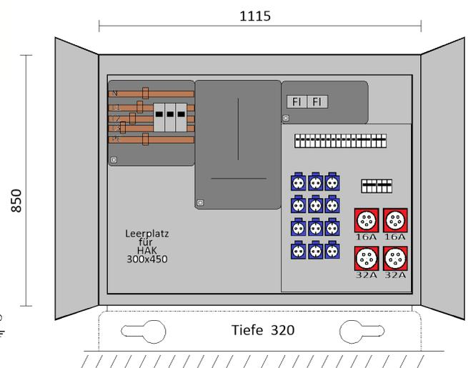
**ELEKTRA** - Stromverteilerschrank in glasfaserverstärkten Kunststoffgehäuse, RAL 7035, bestückt mit:
