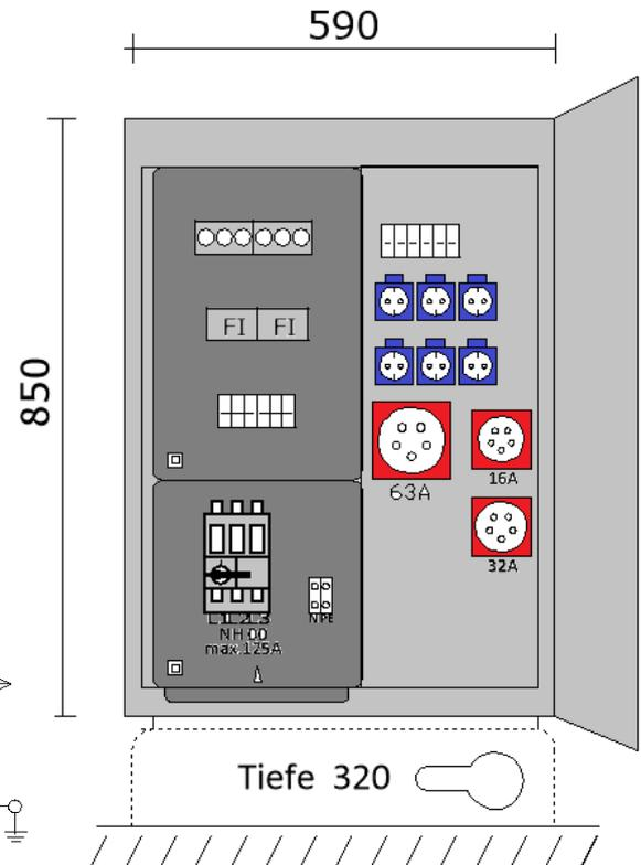
**ELEKTRA** - Stromverteilerschrank in glasfaserverstärkten Kunststoffgehäuse, RAL 7035, bestückt mit:
