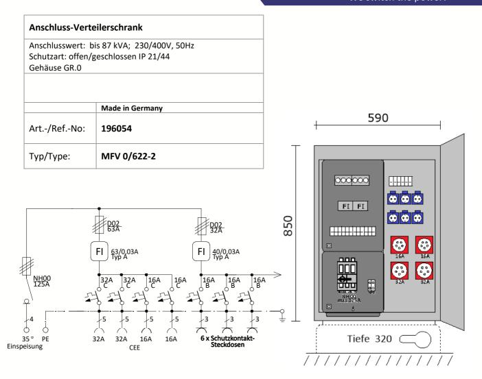
ELEKTRA - Stromverteilerschrank in glasfaserverstärkten Kunstoffgehäuse, RAL 7035, bestückt mit:
