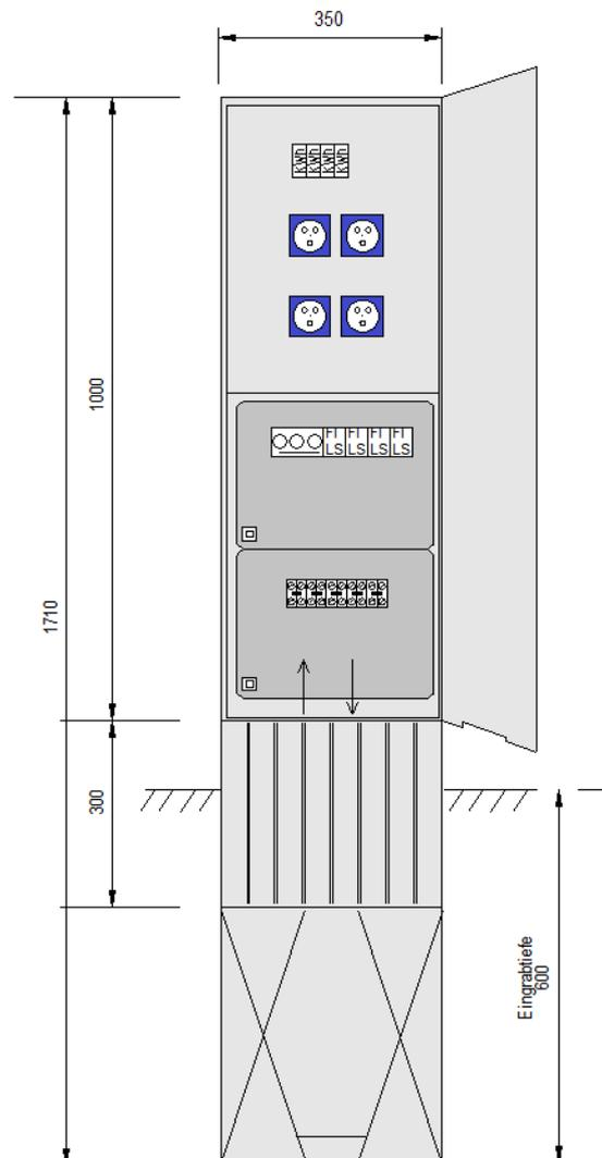
**ELEKTRA** - Stromverteiler-Schrank aus glasfaserverstärktem Polyester (GFK) mit angespresstem Sockel und Regenschutzdach. Schutzart IP 44, Farbe hellgrau; Türe mit Sicherheitsschloss.
