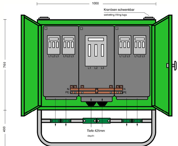
**ELEKTRA** - Gruppenverteilerschrank im Gehäuse aus verzinktem Stahlblech, pulverbeschichtet RAL 6018, bestückt mit:
