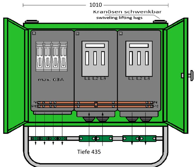
**ELEKTRA** - Gruppenverteilerschrank im Gehäuse aus verzinktem Stahlblech, pulverbeschichtet RAL 6018, bestückt mit:
