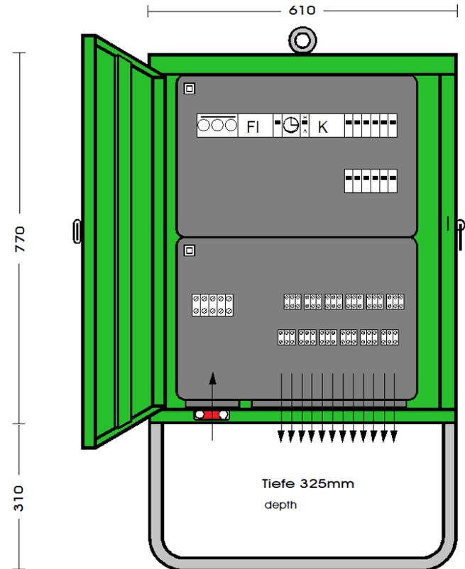
**ELEKTRA** - Verteilerschrank im Gehäuse aus verzinktem Stahlblech, pulverbeschichtet RAL 6018, bestückt mit:
