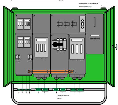
**ELEKTRA** - Anschlussschrank im Gehäuse aus verzinktem Stahlblech, pulverbeschichtet RAL 6018, bestückt mit:
