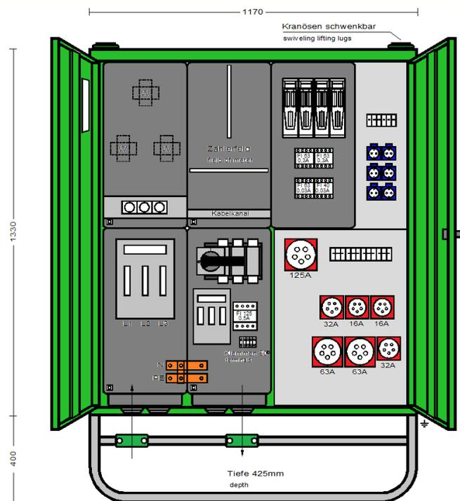
**ELEKTRA** - Anschlussverteilerschrank im Gehäuse aus verzinktem Stahlblech, pulverbeschichtet RAL 6018, bestückt mit:
