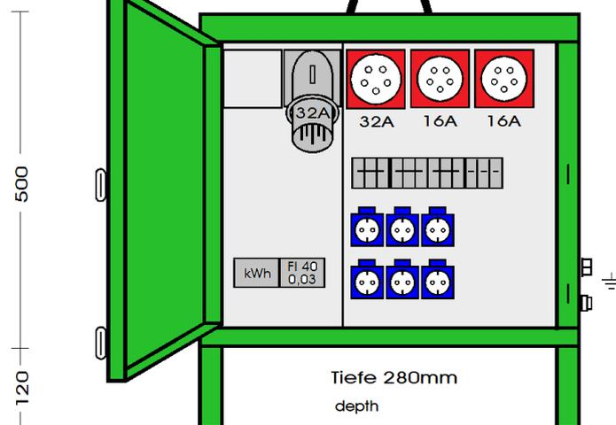
**ELEKTRA** - Endverteilerschrank im Gehäuse aus verzinktem Stahlblech, pulverbeschichtet RAL 6018, bestückt mit:
