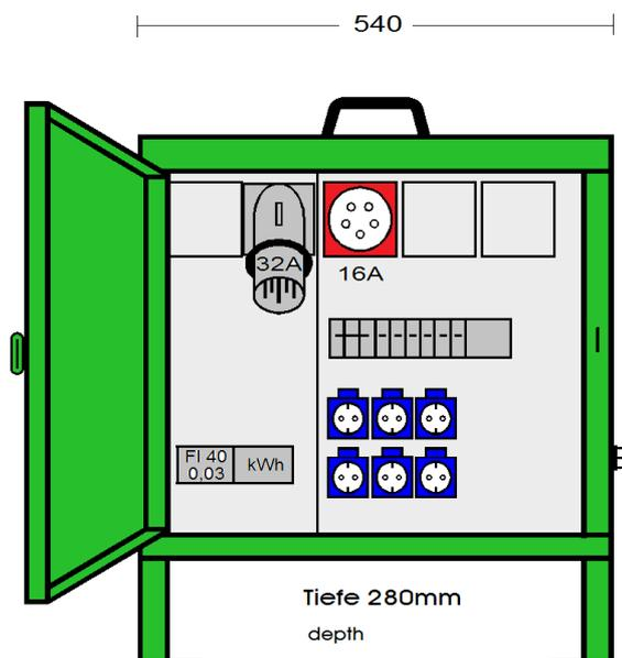
**ELEKTRA** - Endverteilerschrank im Gehäuse aus verzinktem Stahlblech, pulverbeschichtet RAL 6018, bestückt mit:
