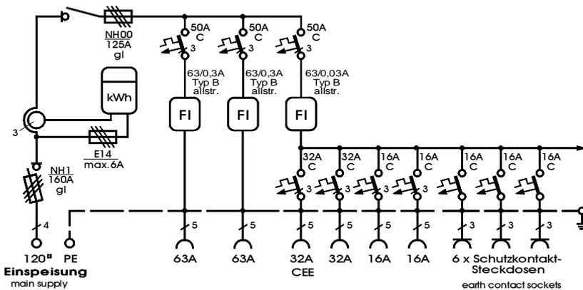
**ELEKTRA** - Anschlussverteilerschrank im Gehäuse aus verzinktem Stahlblech, pulverbeschichtet RAL 6018, bestückt mit:
