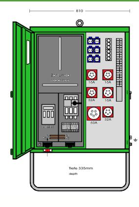
ELEKTRA - Anschlussverteilerschrank im Gehäuse aus verzinktem Stahlblech, pulverbeschichtet RAL 6018, bestückt mit:
