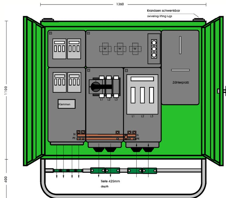
**ELEKTRA** - Anschlusschrank im Gehäuse aus verzinktem Stahlblech, pulverbeschichtet RAL 6018, bestückt mit:
