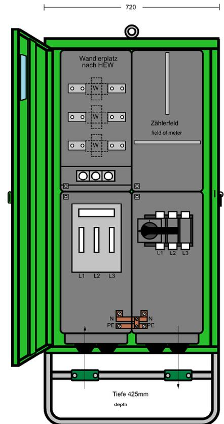
**ELEKTRA** - Anschlusschrank im Gehäuse aus verzinktem Stahlblech, pulverbeschichtet RAL 6018, bestückt mit:
