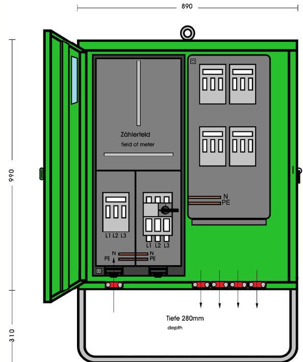
**ELEKTRA** - Anschlusschrank im Gehäuse aus verzinktem Stahlblech, pulverbeschichtet RAL 6018, bestückt mit:
